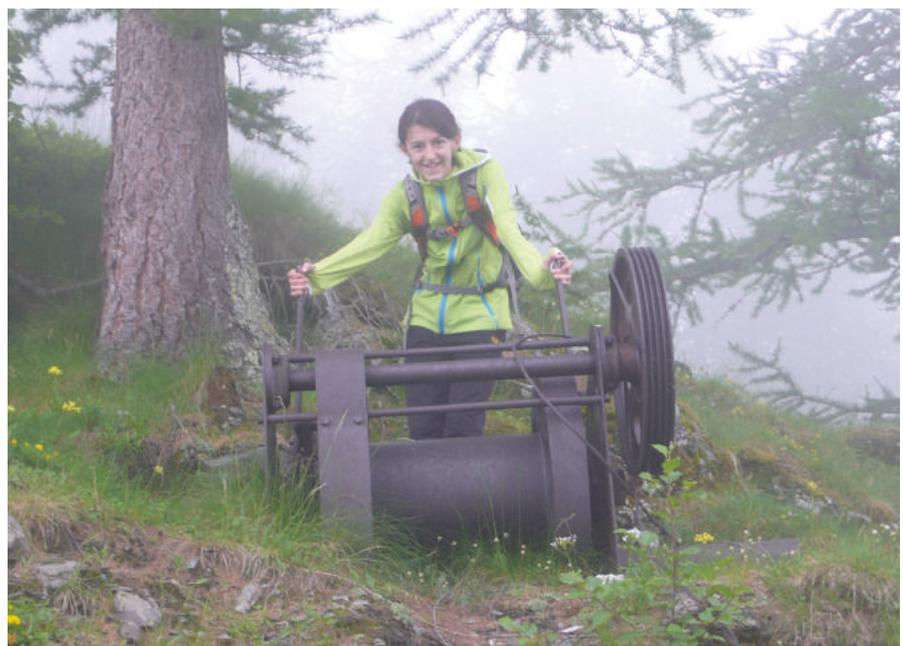
*Lou treulh, l'argano: Elisa si fa fotografare impugnando con una mano la leva del freno e con l'altra quella della frizione. La grossa puleggia in alto a destra era collegata al motore con cinghie trapezoidali e azionava la capace bobina sottostante a cui era avvolta la fune traente.*
